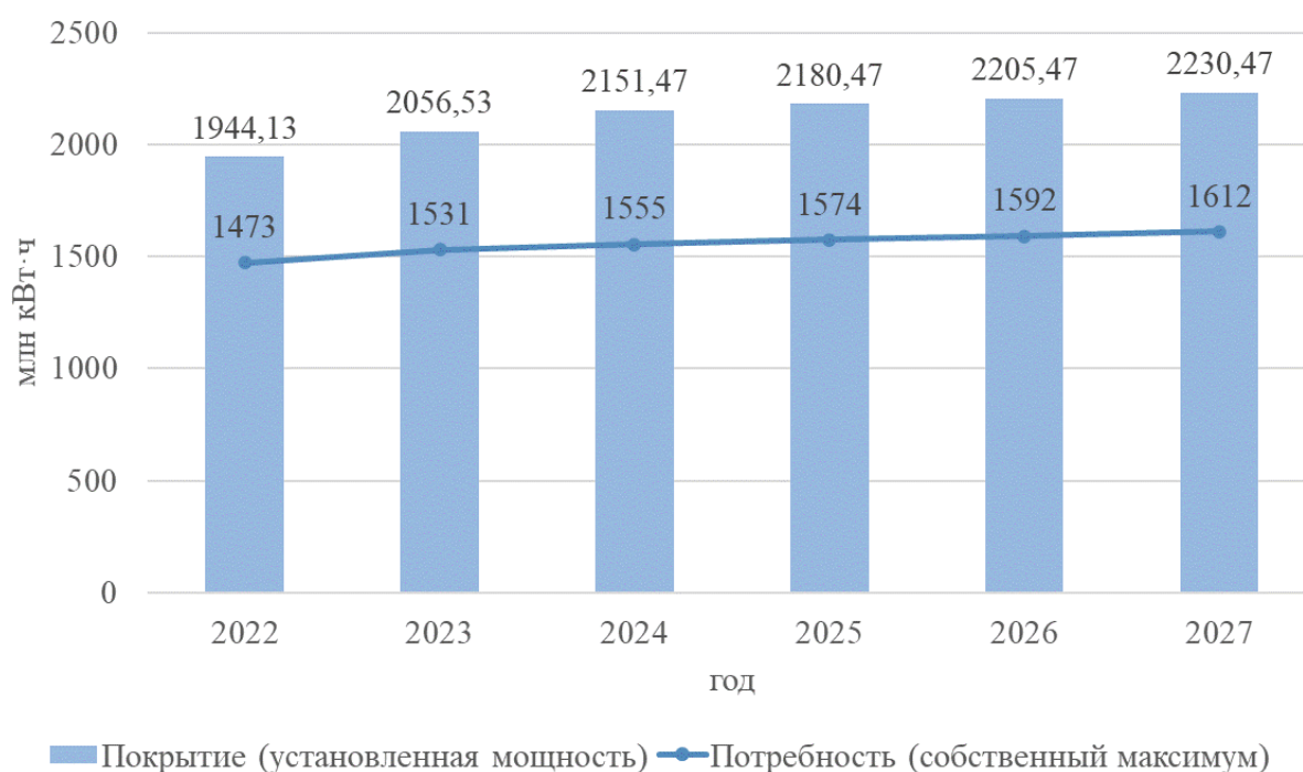
Рисунок 5.2 – Перспективный баланс мощности по энергосистеме Республики Дагестан на период до 2027 года (оптимистический вариант)
